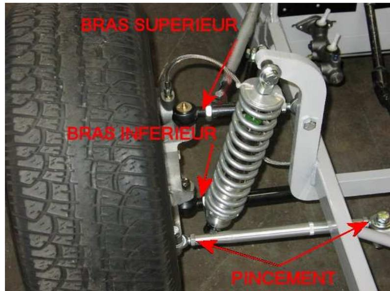
(i) **Pincement (Toe in):** Il facilitera la prise de virage et tout particulièrement la sortie de virage. Réduire le toe in (ou augmenter le toe out) rendra la voiture sensiblement plus stable en sortie de virage.
